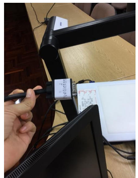
ภาพที่ 3 นำสายเครื่องต่อโปรเจคเตอร์ ต่อเข้ากับเครื่องเปลี่ยนอุปกรณ์
